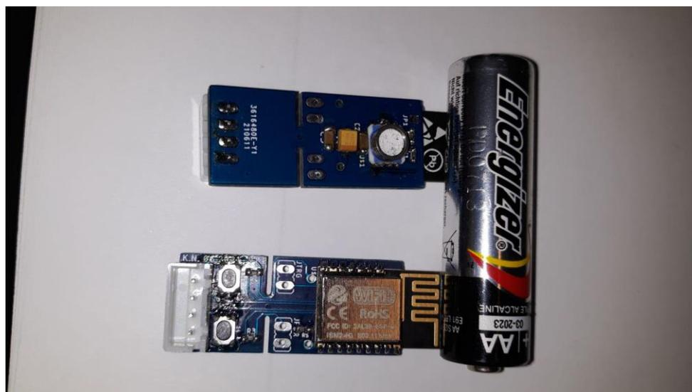
Fig. 2 Sensore di misura della pressione e temperatura (*sopra*), e confezionamento per essere inserito in una bottiglia di vino (*sotto*).
