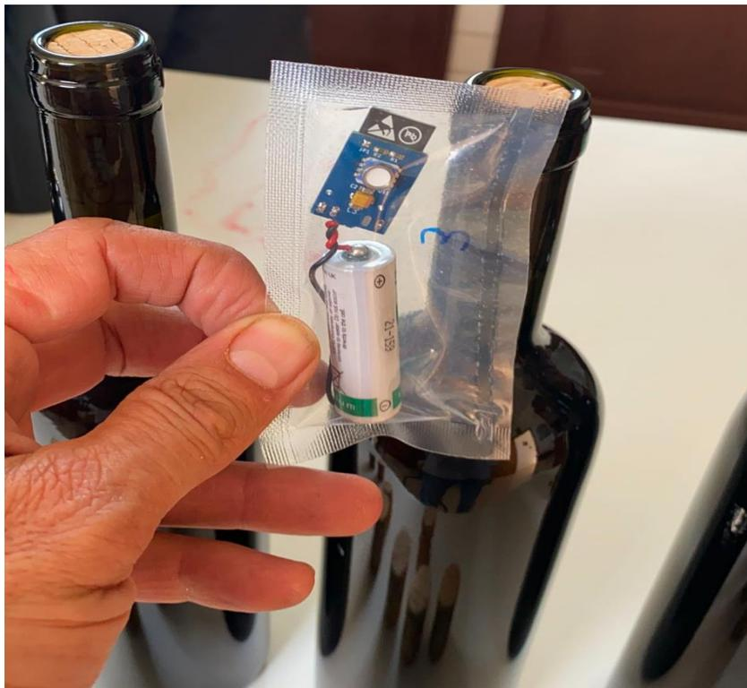
I dati letti vengono immagazzinati in un file all'interno del microcontrollore, e vengono poi letti da una postazione remota, tramite una connessione WiFi. L'intervallo temporale di registrazione, così come il formato dei dati, sono configurabili e modificabili all'interno del Firmware (FW) sviluppato.
