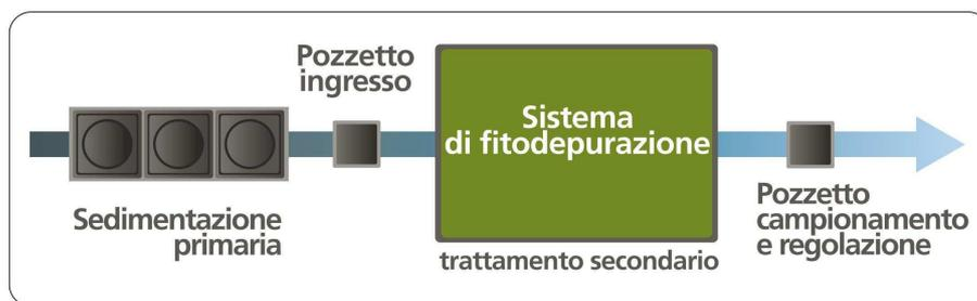
Figura 3.9 – Schema generale sistema di fitodepurazione
